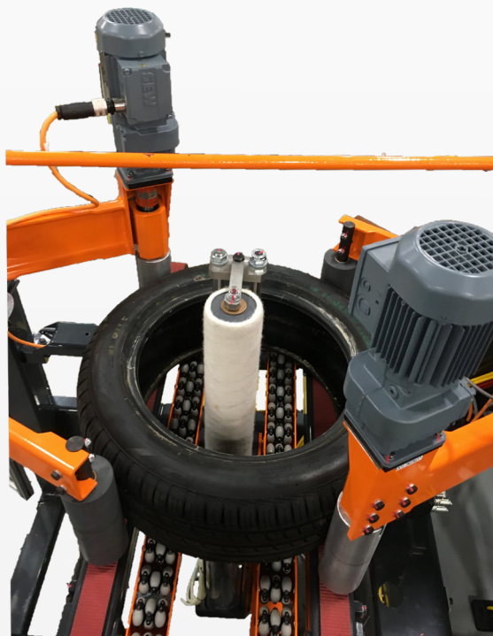
胎圈润滑的同时通过定中抱臂旋转带动轮胎旋转
